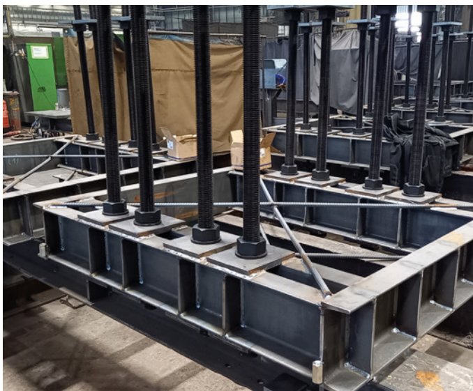
Obr. 6 Kotevný prípravok vo výrobnej hale (zdroj: STRABAG Rail a.s.)
