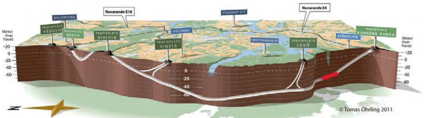
Obr. 2 Schematický řez stavbou E4 Förbifart Stockholm (zdroj: Trafikverket, 2022)
