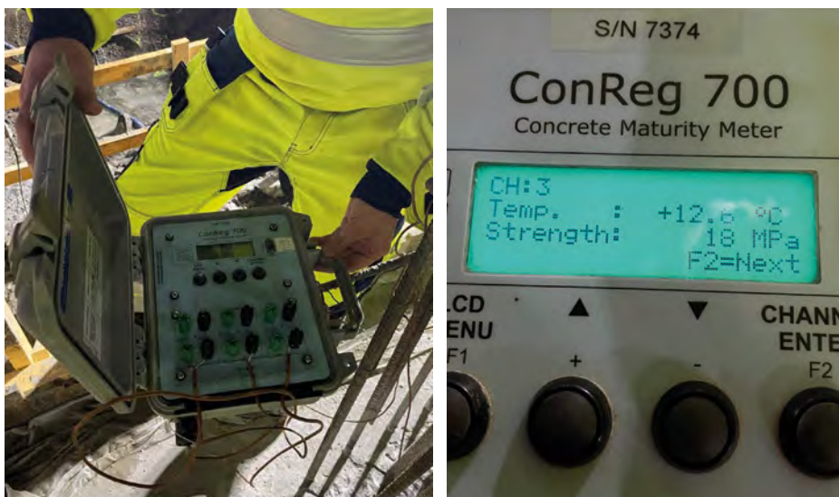
Obr. 13 Měření zralosti betonu pro stanovení času odbednění konstrukce
