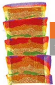
Obr. 5 Vyhodnocení skutečné tloušťky sekundárního tunelového ostění HT201 (zdroj: Subterra a.s.)
