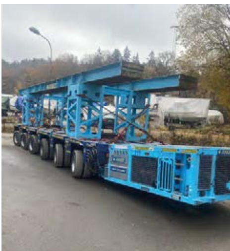
Obr. 8 Speciální samohybný podvozek pro transport bednění klenby
