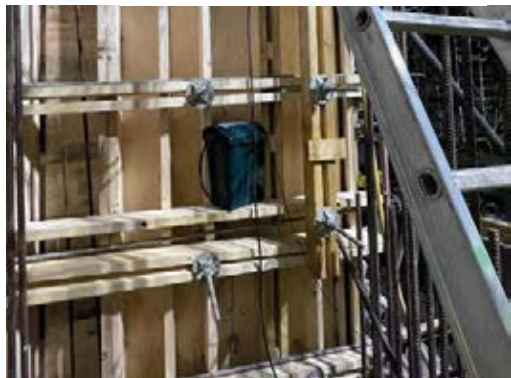
Obr. 6 Měření tlaku čerstvého samozhutitelného betonu (nahore výsledek měření, vlevo datalogger umístěný na bedně, vpravo detail snímače), (zdroj: Subterra a.s.)
